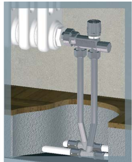
Art. 5921 - Allacciamento di un radiatore per mezzo di un raccordo a "T" con serraggio a pressare su valvola bitubo.
