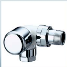
Art. 0112 Valvola termostattizzabile a squadra destra - Attacco intercambiabile per tubo rame, plastica e multistrato - Mis. 3/8" - 1/2"
