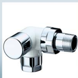
Art. 0132 Detentore a squadra destro - Attacco intercambiabile per tubo rame, plastica e multistrato - Mis. 3/8" - 1/2"
